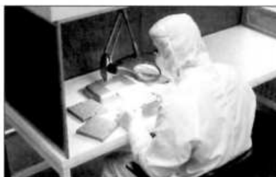
In de replicatechniek wordt een zeer goede vormovername bereikt en kunnen zeer fijne structuren worden gekopieerd.
