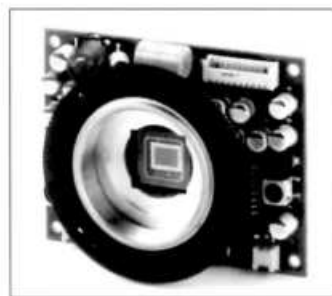
Complete VCM 3305/VCM 3405 cameramodule voor inbouw.
