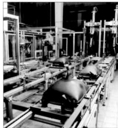
Geautomatiseerde serieproductie van breedbeeldbuizen.
